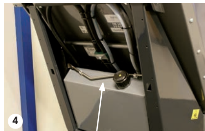
4 Стъргалка за почистване на лопатките на турбината
