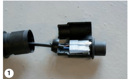
1 Кафяв ел. проводник към + и син ел. проводник към -
